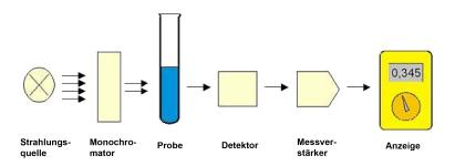
Stoffe absorbieren eine bestimmte Wellenlänge des Lichtes. Die übrige "Intensität" kann gemessen werden. Als Messgröße dient eine Spannung U[mV], die von der Konzentration eines Stoffes S[mg/l] in der Lösung abhängig ist.
