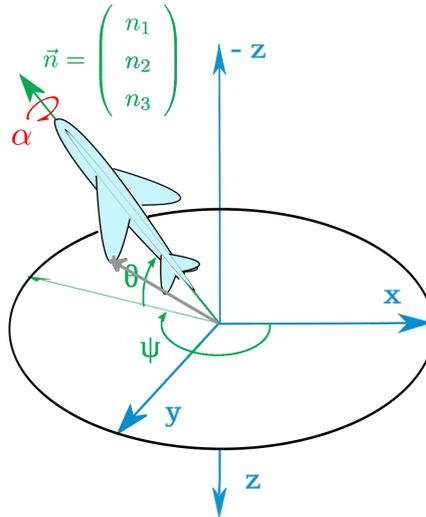
Die Drehmatrix der zusammengesetzten Drehung  $D_{\vec{n}}$  erhält man durch Matrixmultiplikation aus den Matrizen der einzelnen Drehungen um die  $x, y, z$ -Achsen.
