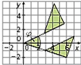
$$A = \begin{pmatrix} \cos \varphi & -\sin \varphi \\ \sin \varphi & \cos \varphi \end{pmatrix}$$
