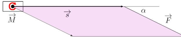
Das Drehmoment ist ein Vektor, der in das Blatt hinein zeigt und eine Länge hat, die dem Flächeninhalt des Parallelogramms zwischen  $\vec{s}$  und  $\vec{F}$  entspricht.
