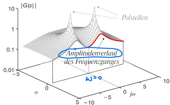
Darstellung des Betrages (Amplitude) einer komplexen Übertragungsfunktion  $G_s$  im Frequenzbereich. Technisch relevant ist nur der Abschnitt für  $\sigma = 0$  sowie für Frequenzen für  $\omega \geq 0$  und spiegelt den Amplitudenverlauf dieses speziellen Übertragungssystemes wider.
