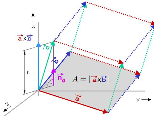
Die Höhe des Spats ist die Projektion des Vektors  $\vec{c}$  auf die Richtung des Normalenvektors  $\vec{n}$ .
