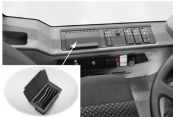
Bild 15.13: Geldablagefach: Von Daimler additiv gefertigt
