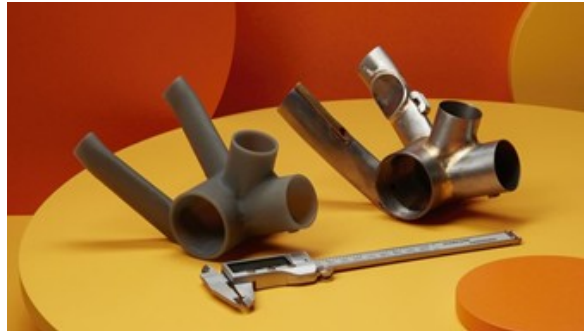
Bild 15.10: Prototyp aus 3D-Druck und Originalteil
