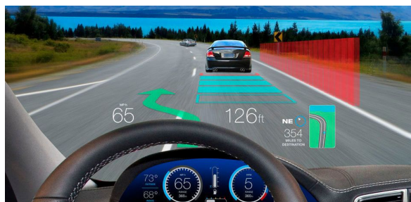
Bild 5.5: Nutzung von AR im Auto: Head-up Display
