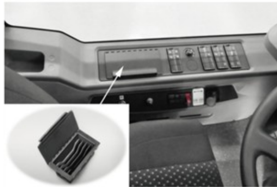
Bild 15.13: Geldablagefach: Von Daimler additiv gefertigt
