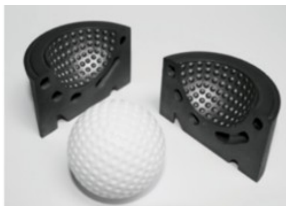
Bild 15.12: Form aus 3D-Druck
