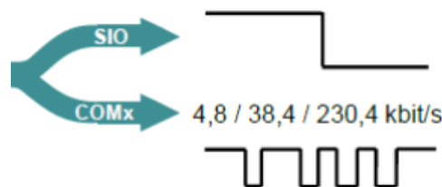
Bild 11.3: Betriebsmodi von IO-Link
