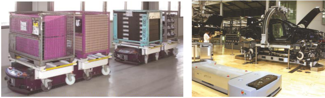
Bild 10.9: links: Unterfahr-FTF mit kleinen Rollenwagen für Gitterboxen, rechts: Montage-FTS bei Volkswagen; im Hintergrund erfolgt die Verheirathung von Antriebsstrang und Karosserie auf einem FTF, vorne entfernt sich ein leeres FTF
