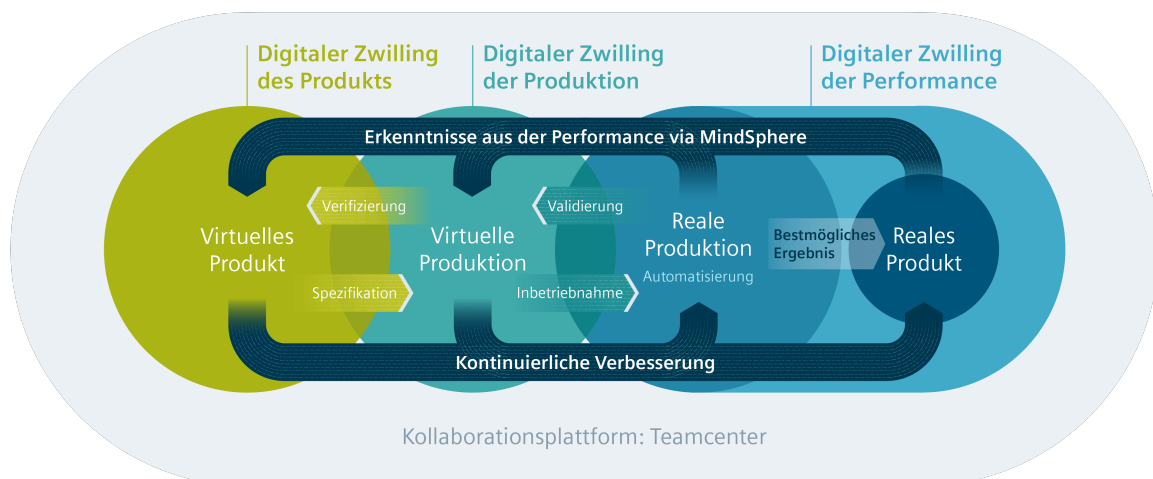
Bild 7.3: Typen des digitalen Zwillings und ihre Verbindung zum realen Produkt [20].
