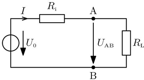
Im Schaltbild der Ersatzspannungsquelle sind die Leerlaufspannung  $U_0$  und der Innenwiderstand  $R_i$  unbekannt. Diese unbekanntenen Größen sollen durch zwei Belastungsversuche mit den Widerständen  $R_1$  und  $R_2$  ermittelt werden.
