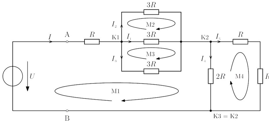
Das Netzwerk besteht aus drei Knotenpunkten, für die nach dem 1. Kirchhoff'schen Gesetz (Knotenpunktregel) zwei unabhängige Gleichungen aufgestellt werden können.
