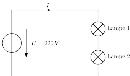
Zwei Glühlampen für  $U_N = 110 \text{ V}$  haben die Leistungsangaben  $P_{1N} = 40 \text{ W}$  und  $P_{2N} = 60 \text{ W}$ . Sie liegen in Reihe an einer Spannung von  $220 \text{ V}$ . Welche Leistungen werden in beiden Lampen umgesetzt?
