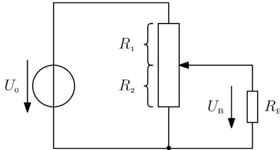
Ein Spannungsteiler mit dem Gesamtwiderstand  $R = R_1 + R_2 = 400 \Omega$  liegt an der Spannung  $U_0 = 100 \text{ V}$ . Wie groß müssen die Teilwiderstände  $R_1$  und  $R_2$  sein, damit am Belastungswiderstand  $R_B = 800 \Omega$  eine Spannung von  $U_B = 40 \text{ V}$  liegt?
