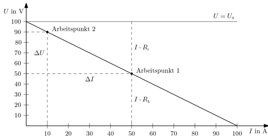
Die Gerade schneidet die Achsen bei der Leerlaufspannung  $U_0$  und dem Kurzschlussstrom  $I_K$ . Die jeweilige Klemmspannung  $U_{AB}$  in den verschiedenen Arbeitspunkten ergibt sich aus  $U_{AB} = I \cdot R_L$ , wobei  $R_L$  der jeweilige Belastungswiderstand ist. Die Differenz zwischen der Leerlaufspannung und der Klemmspannung fällt am Innenwiderstand der Ersatzspannungsquelle ab (Maschengleichung).
