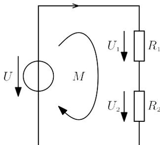
Die beiden Glühlampen werden im elektrischen Ersatzschaltbild als ohmsche Widerstände dargestellt.
